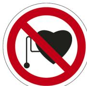
Установите знак в местах и на оборудовании, где запрещено работать или находиться людям с вживлёнными стимуляторами сердечной деятельности. Например, нельзя находиться около высоковольтных линий электропередачи, трансформаторных станций, ретрансляторов, мощных радиостанций, сильных источников электромагнитного излучения и т. п.
