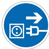
Установите знак на рабочих местах и оборудовании, где требуется отключение от электросети. Например, при наладке или остановке электрооборудования и в других случаях
