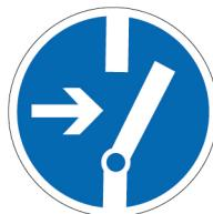
Установите знак на рабочих местах и оборудовании при проведении ремонтных или пусконаладочных работ
