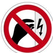
Установите знак на поверхности корпусов, щитов и т. п., где есть возможность поражения электрическим током
